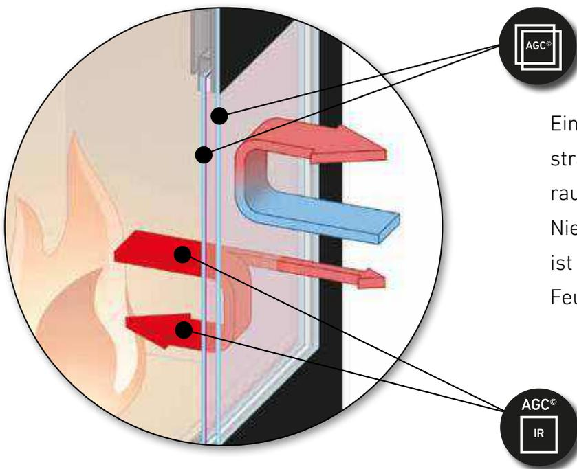
Eine **Doppelverglasung** reduziert die Wärmestrahlung nach aussen und verhindert eine Wohnraumüberhitzung in modern gedämmten Niedrigenergie- und Passivhäusern. Das Resultat ist angenehme Strahlungswärme auch bei grossen Feuersichtscheiben.
