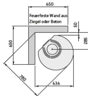
Für brennbare Baubestandteile zugelassener Bereich
