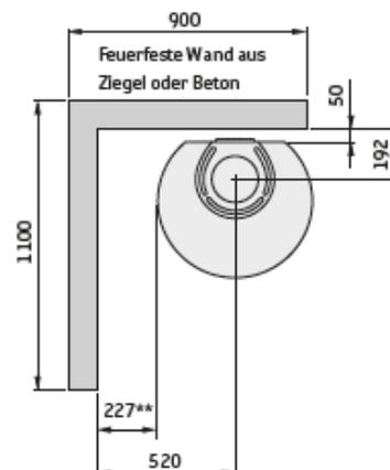
\* Wenn der Kaminofen auf einem Brandschutzbereich z.B. aus Glas (Zubehör) aufgestellt wird, ändert sich die Höhe vom Boden um die Stärke des Brandschutzbereichs. Ein freiliegender Brandschutzbereich aus Glas macht 10 mm aus.
